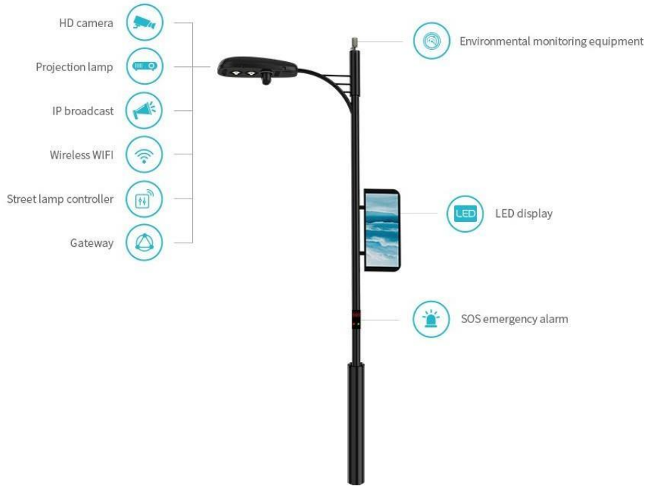
Şekil 28. Akıllı sokak aydınlatması çalışma fonksiyonları [19]
