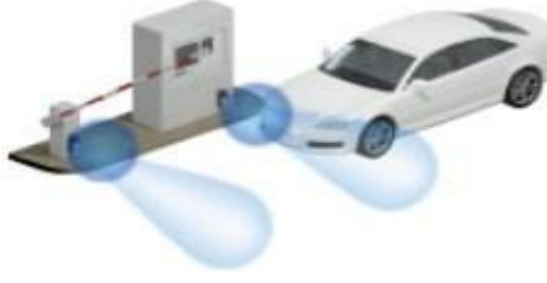
Şekil 20. Araç sayımı: Araçların cadde ve otobandaki trafiğini ölçmek için kullanılan sistem
